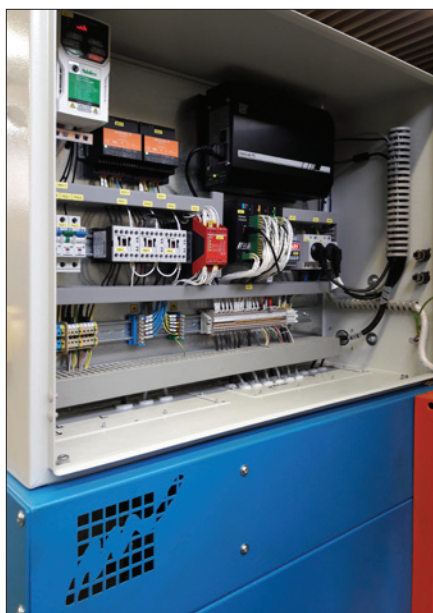
Obr. 1. Rozváděč stroje, který je řízen průmyslovým počítačem DataLab PC a jednotkou vstupů a výstupů Datalab IO se čtyřmi moduly, připojenou prostřednictvím USB; pro obsluhu je k dispozici mimo jiné i dotyková obrazovka
