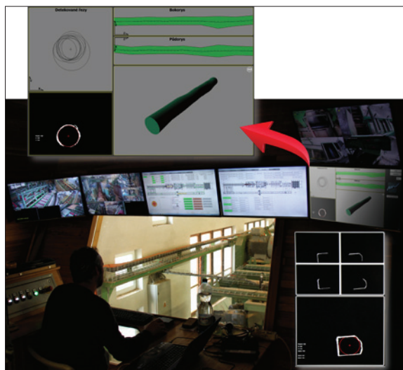
Obr. 4. Komplexní automatizace zpracování dřeva: systém pracuje s 3D modely – digitálními dvojčaty kmenů, získanými pomocí strojového vidění
